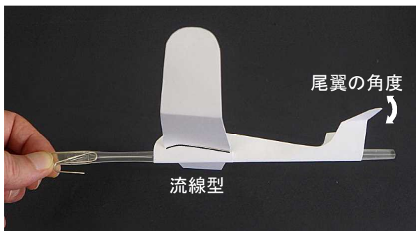
主翼の流線型と尾翼の角度
