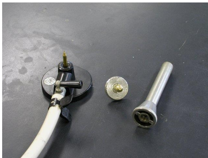
ガスバーナーの構造
