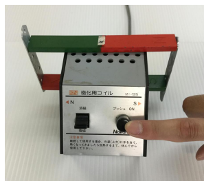
① 着磁装置に入れる (強力な磁場の中に入れる)
