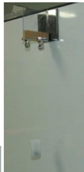
2枚の板の間に糸を挟み輪ゴムで固定      クリップで大型フックに取り付け
