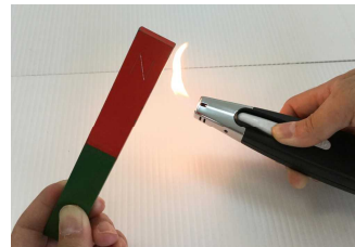
② 加熱する (熱振動を与える)
