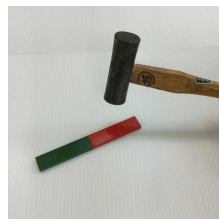
① 磁石に強い振動を与える (叩く、ぶつける)
