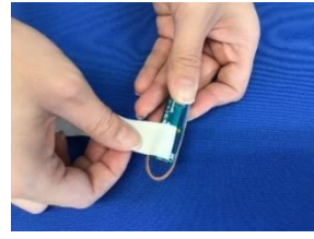
乾電池の両端にビニールテープを巻き重ね、厚みを作る
