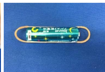
セロハンテープで固定後、輪ゴムの両端をバランスよく引っ張り、図のように乾電池の両側に同じくらい輪ゴムを出しておく
