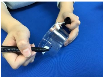
取り付けたい高さの位置に油性ペンで印をつける
