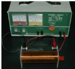
鋼製磁石を入れたコイルに直流を流すと磁力が増す。
