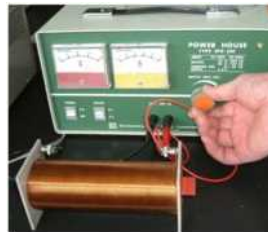
鋼製磁石を入れたコイルに交流をかけ、電圧を下げていくと磁力を消せる。
