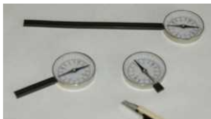
長さ方向着磁では切り口が磁極になる
