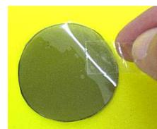
(5) カラー工作用紙 A、B の裏面の両面テープの剥離紙を剥がして、中心に偏光シートを挟んで貼り合わせます。
