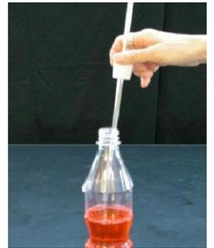
(3) ガラス管の中を色水が上がってくる。シリコン栓の押し込む割合によって、色水の高さを調節する。
