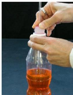
(4) 水平な場所にペットボトル温度計を置き、ガラス管中の水の高さを読みとる。
