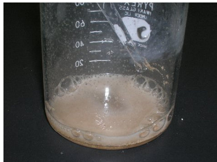
塩酸と石灰質砂岩の反応
