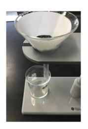
操作9 ろ液を全て 100 mL ビーカーに入れ,50mL ビーカーを軽く蒸留水で洗浄し,その洗液も100 mL ビーカーに入れる。100 mL ビーカーにアルミニウム箔でしっかりふたをして,中心に直径5 mm 程度の穴を開け,ガスコンロで弱火で加熱する。
