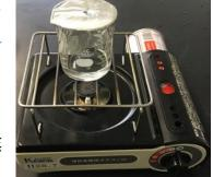
操作 10 ろ液が完全に乾固してアルミホイルの穴から水蒸 気がでなくなったら火を消し、ビーカーを放冷する。
