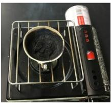
操作5 内容物が灰になったら(煙が出なくなる),蒸発皿を金属パレットの上にピンセットで移動させ、冷却する。
