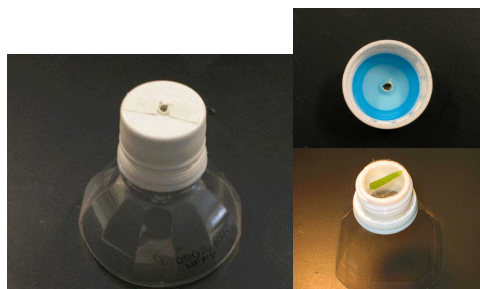
ペットボトルで作った顕微鏡
